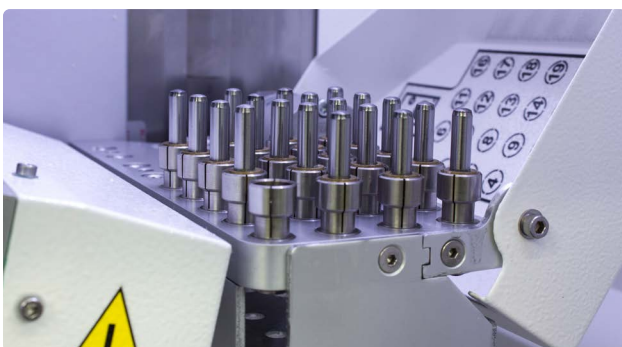
Werkzeughalter für bis zu 20 Werkzeuge
